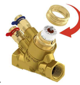
Montaje de válvula y actuador electromecánico. Carrera de la válvula 3mm. Adaptador 0A7010 no incluido con el actuador. Fuerza máxima 160N
