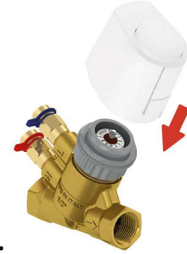
Montaje de válvula y actuador termoeléctrico. Carrera de la válvula 3 mm. Adaptador VA64
