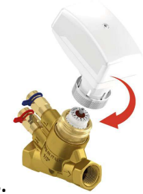
Montaje de válvula y actuador electromecánico. Carrera de la válvula 3mm. Adaptador 0A7010 no incluido con el actuador. Fuerza máxima 160N
