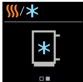
La refrigeración está activa
