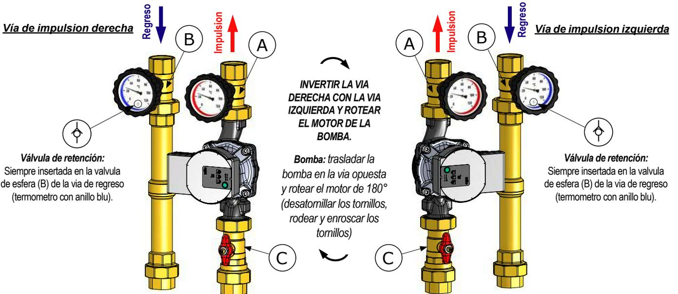
(A) Válvula de esfera en la vía de impulsión (termómetro con anillo rojo)
