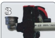
Colocar las cunas RF-Z, U o TH según el tipo de tubo (pex o multicapa) y prensar comprobando que cierra correctamente.
