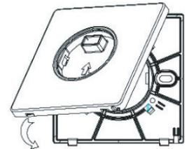
7. Por último colocar la cabeza del termostato para finalizar la instalación.
