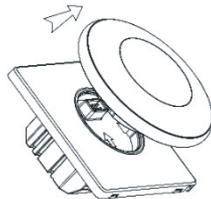
2. Extraer la carcasa que cubre los tornillos de anclaje a la pared con la ayuda de un destornillador como se muestra en la imagen
