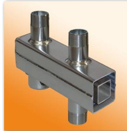
Colectores de distribución DN25 para instalaciones de calefacción, fabricado con electro-soldadura y tubos de hierro galvanizado adecuado para potencia de hasta 70 kW. Aislamiento térmico de EPS 25 mm según DIN 4102-B2 y cubierta de acero galvanizado con espesor 0,55 mm. Prueba hidráulica a 12 bar. Distancia entre ejes de conexión 125 mm. La gama de los colectores de DN25 1" para grupos de bombeo Ferco, DN32 1/4" (con adaptadores especiales)
