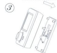
3. Sujete la parte delantera del termostato a la placa posterior.
