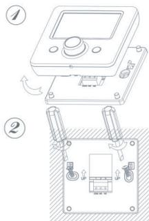
2. Atornille la placa posterior del termostato firmemente en la pared con los tornillos provistos
