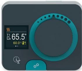
Los controladores de temperatura constante ACD10 y ACD20 están diseñados para el control de temperatura constante en tuberías. La configuración del controlador se realiza con un teclado y una pantalla gráfica, que se utiliza para indicar las temperaturas reales y otros datos. El actuador incorporado está diseñado para el control de la válvula mezcladora. El controlador está conectado a la red eléctrica con un cable de alimentación precableado.
