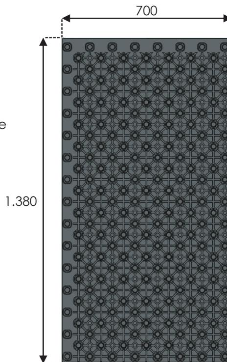
**Información Técnica de Tetones en el Diseño Placa Suelo Radiante**
